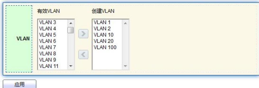
2. 配置 SwitchA 以太网接口 GE2 与 GE3 为 Hybrid 模式。单击导航树中的“VLAN 功能 > VLAN 配置 > 端口配置”菜单, 选择 GE2、GE3, 点击修改, 选择端口模式为 Hybrid:
